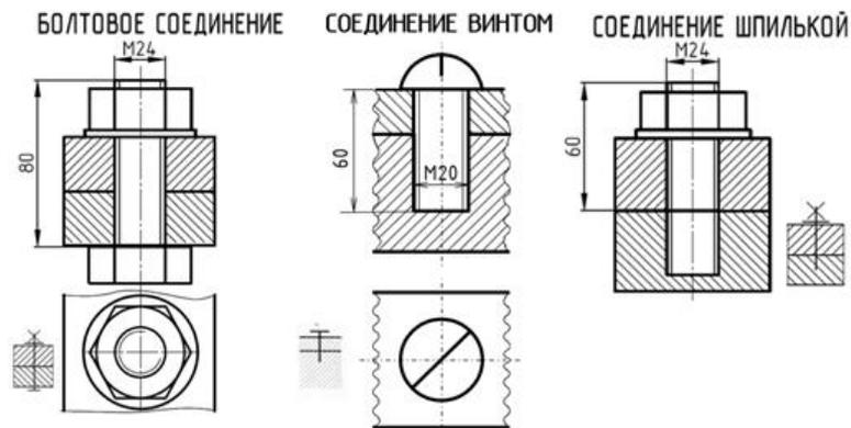
2. Расчетно-графическая работа «Деталировка сборочного чертежа»
